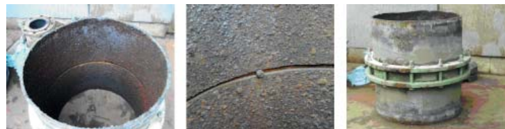
A Szabadság hídról 2008-ban kiszereelt csőkötés különböző nézetekben
